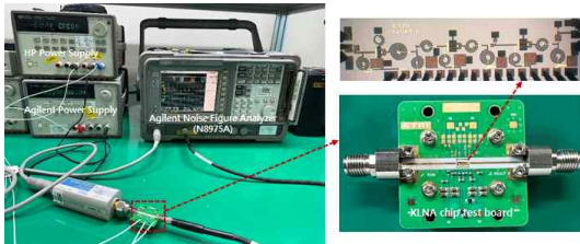
그림 10. GaN 저잡음증폭기 MMIC 잡음지수 특성 측정 셋업 Fig. 10. Measurement setup of the noise figure of GaN LNA MMIC.
