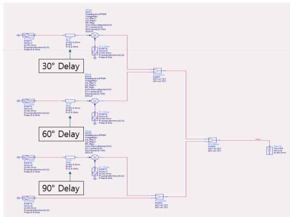
그림 5. 4채널 다중 위상 변조 시뮬레이션 회로 Fig. 5. Simulation circuit of 4-channel multi-phase modulation.
