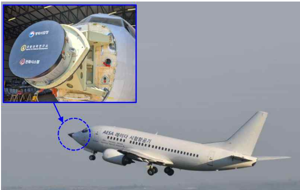
그림 3. 레이더 시스템 및 시험 항공기 Fig. 3. Radar system and FTB.
