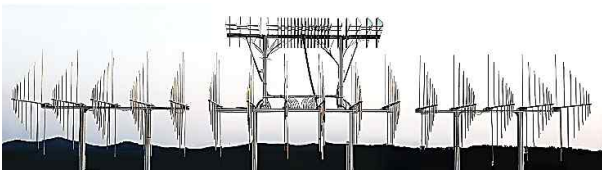
그림 4. 실제 데이터 획득 및 검증에 사용된 광대역 안테나 배열 테스트베드
