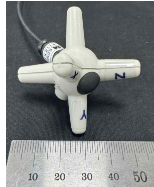
그림 8. EP-603 전기장 프로브 Fig. 8. EP-603 E-field probe.
