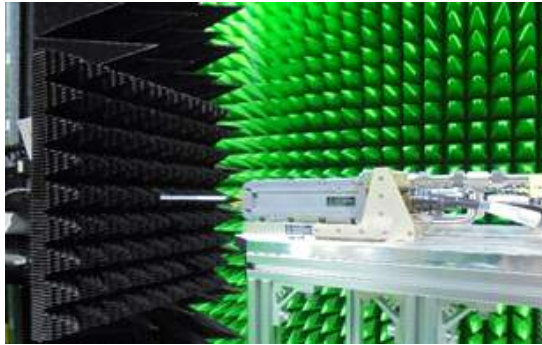
그림 11. 재머 송신 시스템 근접전계 시험 사진 Fig. 11. Picture of near-field test setup for jamming transmitter system.
