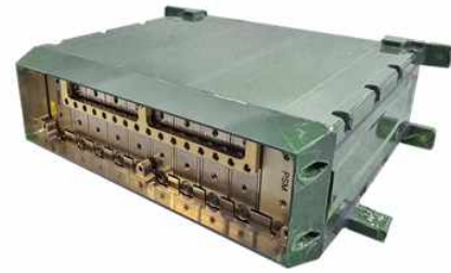
그림 4. 제안된 고출력송신기의 제작 형상 Fig. 4. Fabrication configuration of the proposed high-power transmitter.
