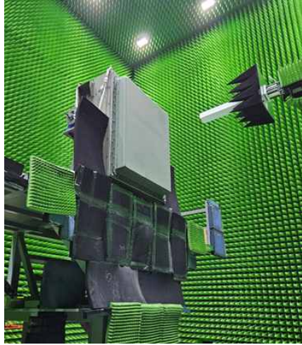
그림 4. 안테나부 근접전계 시험 구성 Fig. 4. Set-up configuration of near-field test.
