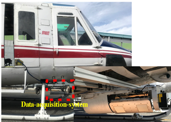
그림 8. 데이터수집장치의 항공기 탑재 사진
