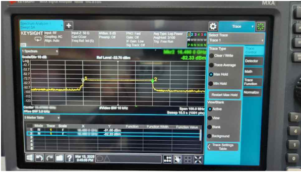
그림 13. LFM 송신신호에 대한 커플링신호 제거모듈 성능시험 결과(40 MHz 대역폭) Fig. 13. Coupling signal cancellation module performance measurement about transmitted LFM signal (40 MHz bandwidth).
