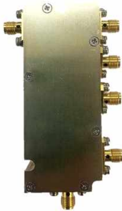
그림 7. 설계된 커플링신호 제거모듈 제작 형상 Fig. 7. Designed coupling signal cancellation module and manufacturing shape.
