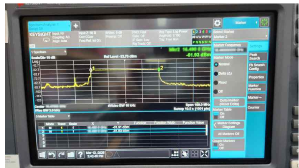
그림 12. LFM 송신신호에 대한 커플링신호 수신레벨 측정 결과(40 MHz 대역폭) Fig. 12. Measured coupling signal level about transmitted LFM signal (40 MHz bandwidth).
