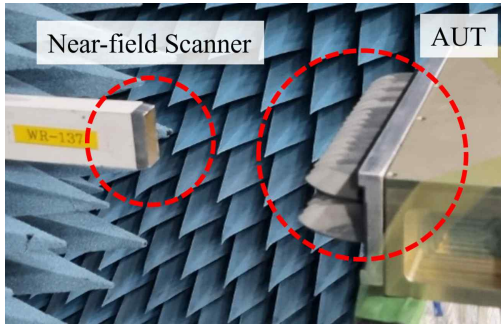
(a) 제안된 배열 안테나 형상 (a) Proposed array antenna configuration (b) 근접장 스캐너 측정 환경 (b) Measurement setup with near-field scanner
