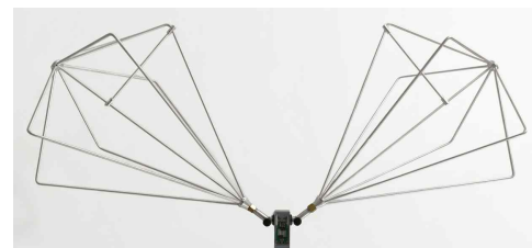
(b) 제작한 브이형 쌍원뿔 다이폴 안테나 사진 (b) Fabricated biconical vee dipole antenna
