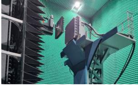
그림 10. 탐색안테나장치 근접전계 시험 Fig. 10. Surveillance antenna unit near-field test.
