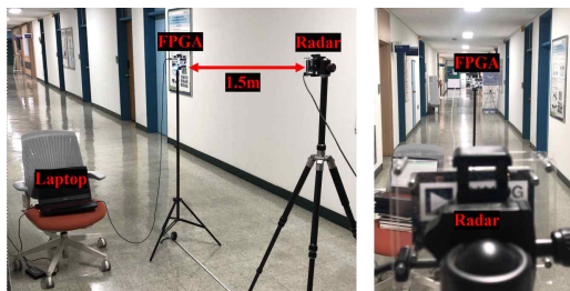
그림 3. Radar를 이용한 비접촉식 HT 탐지 시험 환경 Fig. 3. Radar-based remote HT detection setup.
