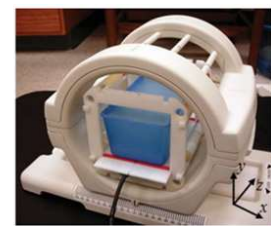
(b) Agar-gel 팬텀 아래에 가열 코일을 배치 (b) Heating coil underneath agar-gel phantom
