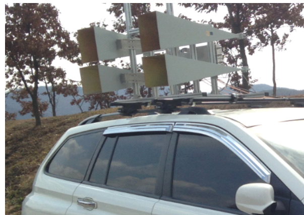
그림 8. 자동차 장착 형상 Fig. 8. Automotive mounting configuration.
