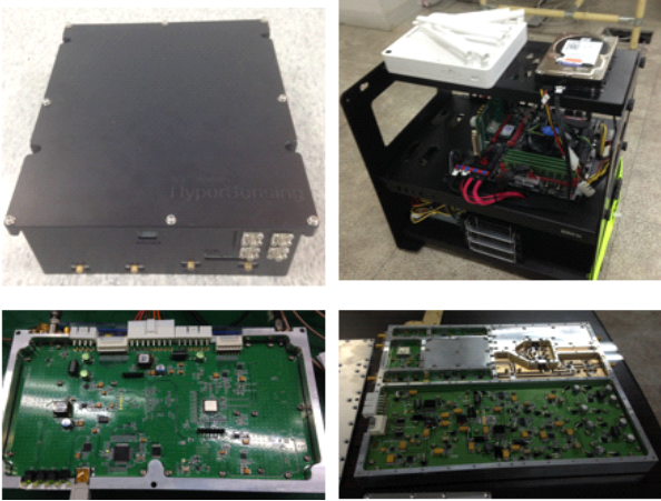
그림 2. 소형 SAR 시스템의 실제 형상 Fig. 2. Actual pictures of a small SAR system.
