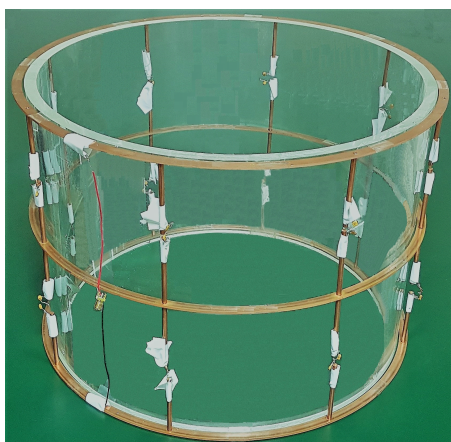
그림 11. TER RF 코일 제작 사진 Fig. 11. Photograph of the TER RF coil.
