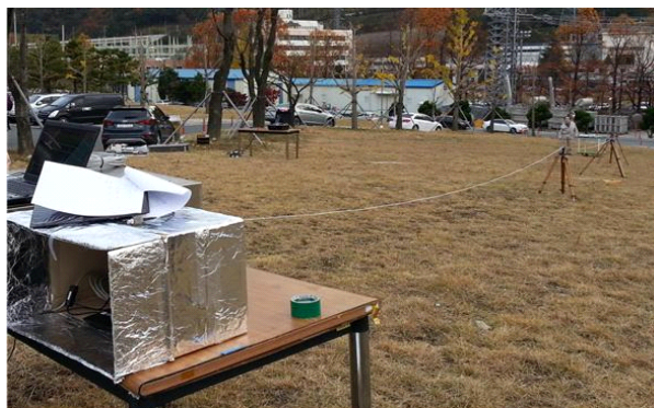
그림 17. LAN 케이블의 EMP 노출 실험 전경 Fig. 17. Photograph of LAN cable's EMP exposure experiment.
