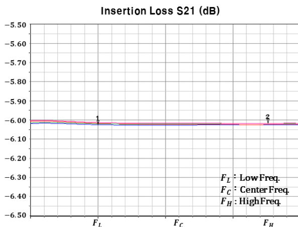
그림 12. 단위전력증폭모듈 송신출력결합기 시뮬레이션 결과 Fig. 12. The simulation result of unit power amplifier module combiner.
