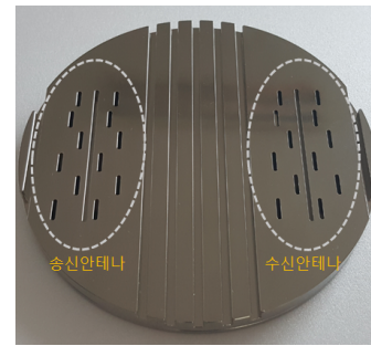
그림 6. 안테나 구조 Fig. 6. The structure of the antennas.
